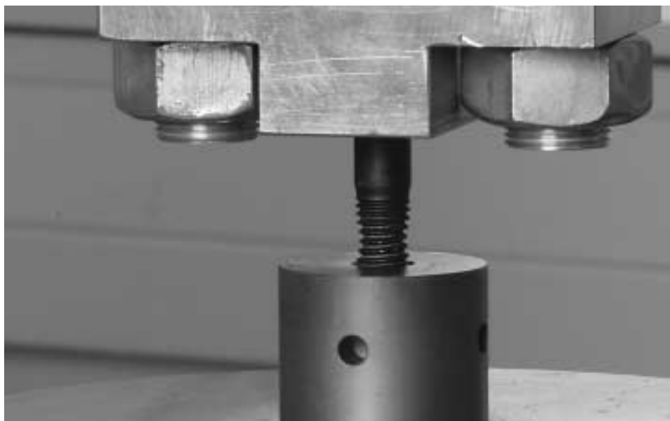
Zugversuch mit einer Schraube
